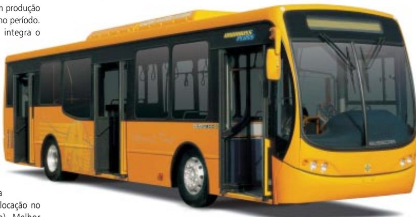
introduziu a estrutura de aço tubular e a chapa galvanizada, que aumenta a vida útil do produto, e o conceito de ergonomia, que valoriza o bem estar do motorista e o conforto e segurança dos passageiros.
