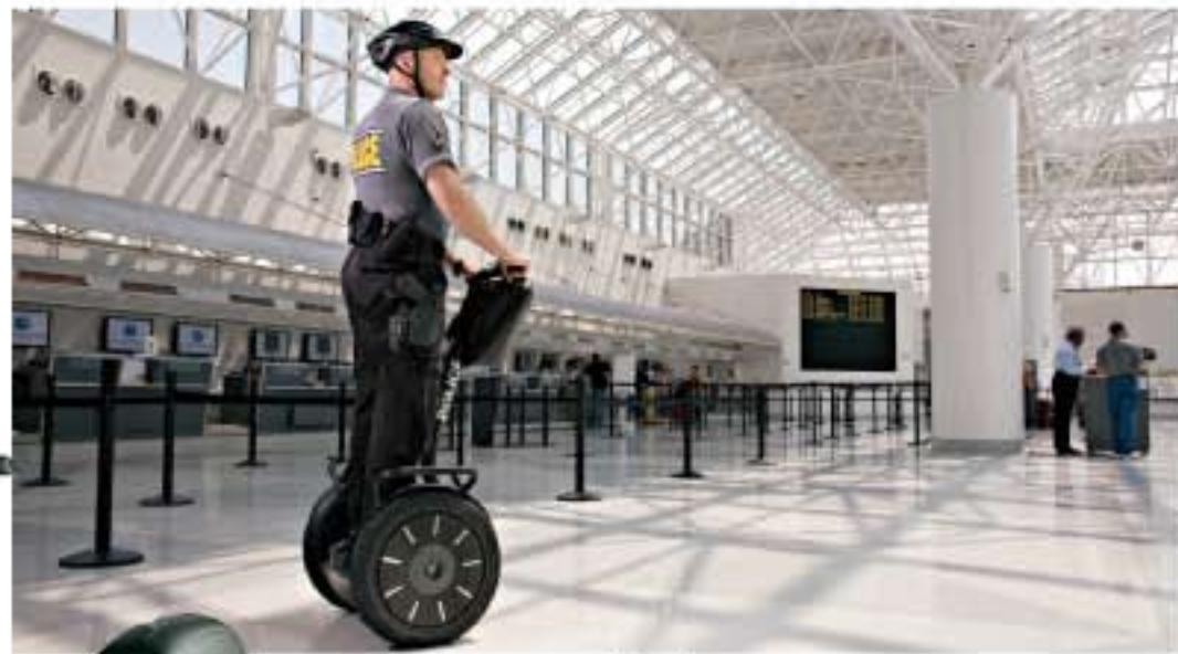
Postiže maksimalnu brzinu od 20 km/h uz doseg od 39km s jednim punjenjem. Teži svega 50-ak kilograma, a vozač nema nikakvih upravljačkih kontroli, već ubrzanje, kočenje i skretanje vrši isključivo nagibom tijela.
